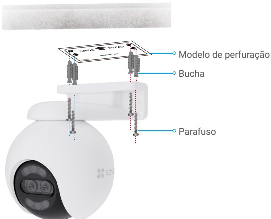
Fig. 1 Montagem no teto
